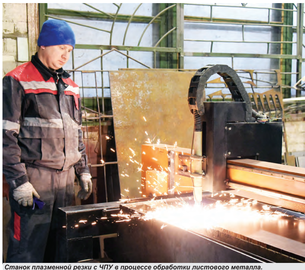
Станок плазменной резки с ЧПУ в процессе обработки листового металла.
