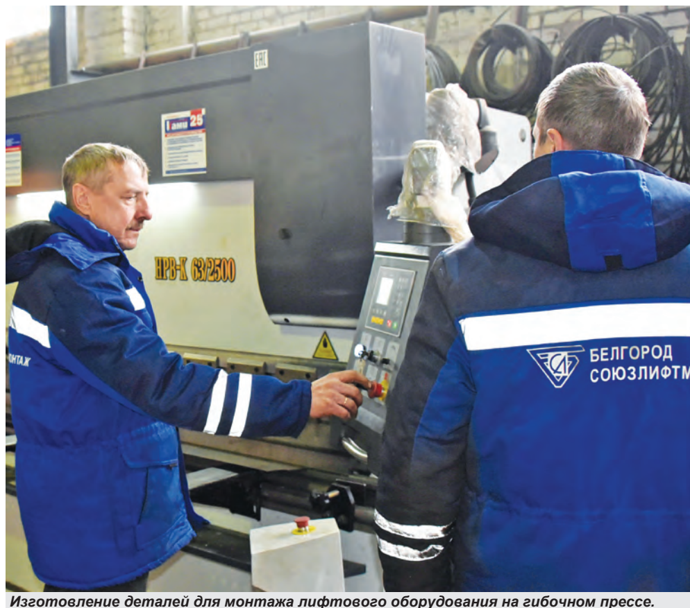
Изготовление деталей для монтажа лифтового оборудования на гибочном прессе.
